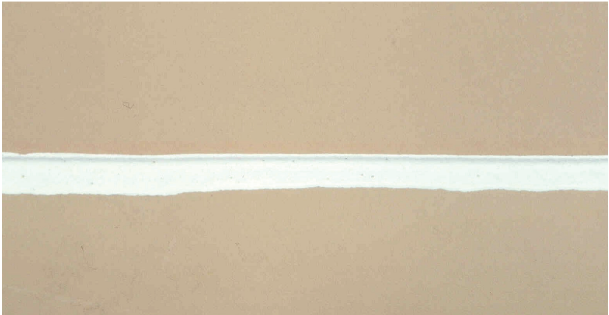
Abb. 3: Naht der geprüften Bahn
