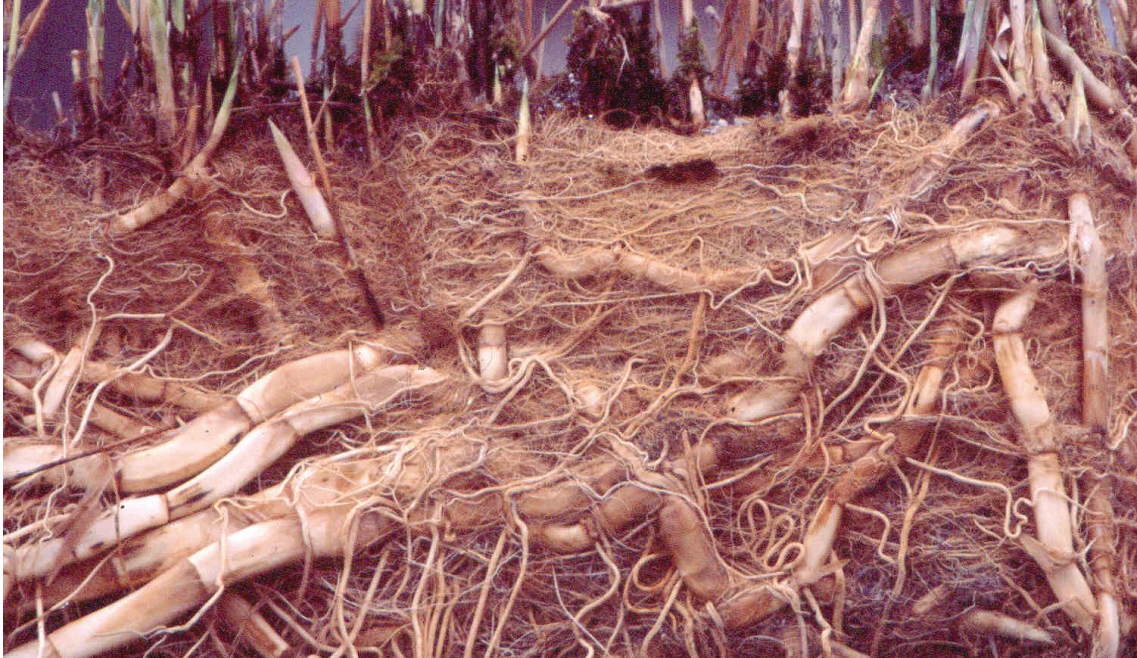
Abb. 1: Dichtes Geflecht aus Schilf-Rhizomen in den Prüfgefäßen nach 2 Jahren Standzeit
