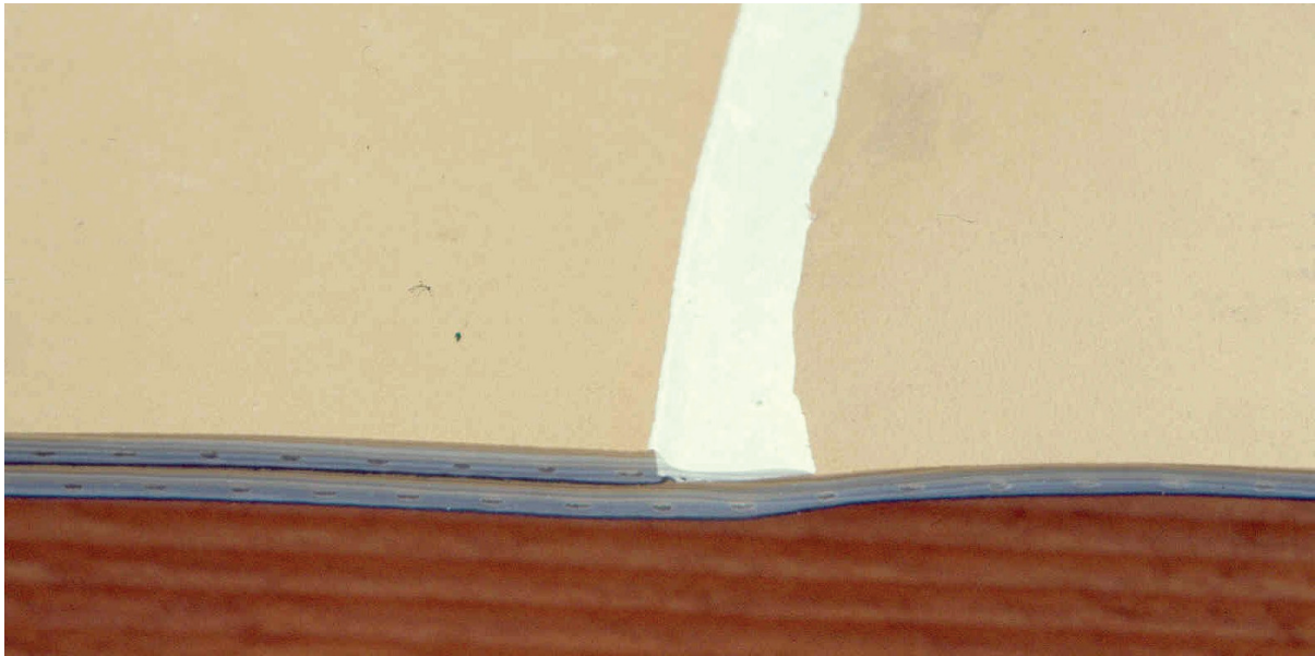
Abb. 5: Schnitt durch eine Naht der geprüften Bahn
