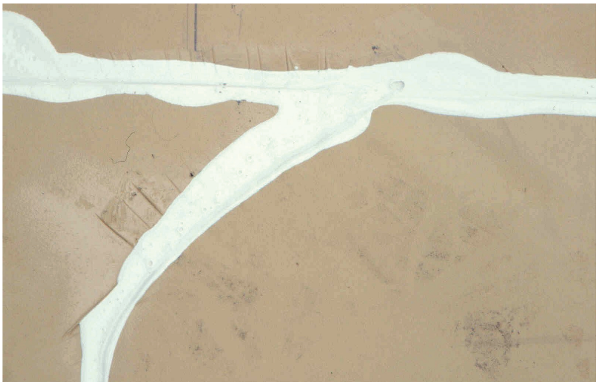
Abb. 4: T-Stoß der geprüften Bahn
